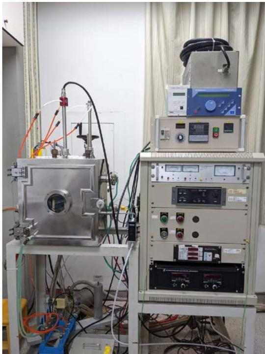
步驟一：製作P型半導體Cu<sub>2</sub>O，並經由各種測量方法測量其品質。
