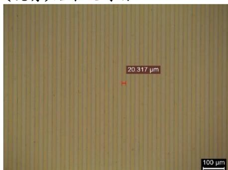
圖(五)光學顯微鏡下的高深寬比結構光柵
